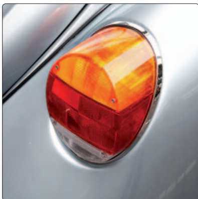
Die Rückleuchten und Blinker der Autos bestehen seit jeher aus Acrylglas.
