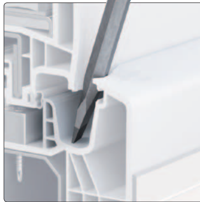
Doppelwandiger Mittelsteg erschwert das Einstecken mit einem spitzen Werkzeug
