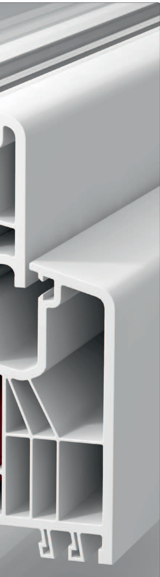
Der solide doppelwandige Mittelsteg erschwert das Einstechen mit einem Hebelwerkzeug und schützt auf diese Weise den Beschlag.
